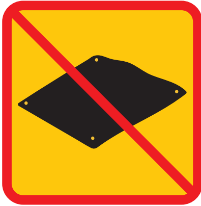
通気性の悪いシートの使用 ※防水性、ビニール製、ブルーシート等
